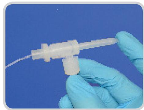
Backflushing a C-Flow Nebulizer
